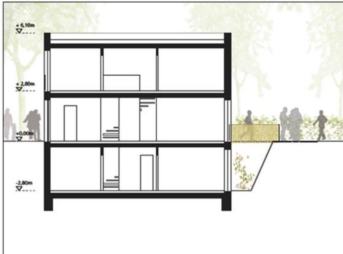
Abbildung 5: Geplante Reihenhausbebauung mit Abgrabung zur Belichtung des Untergeschosses und Verbindungssteg (ohne Maßstab).
