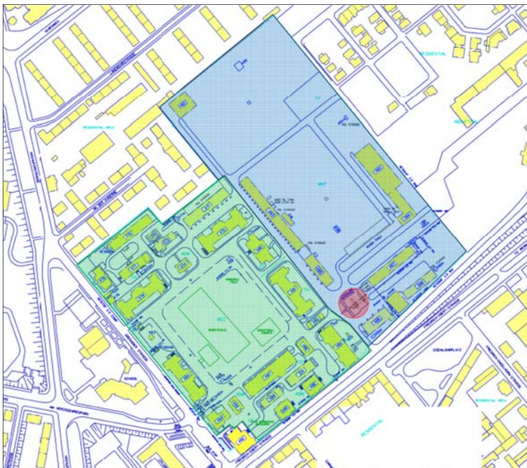
Abbildung 7: Lage der ermittelten Bodenverunreinigungen
